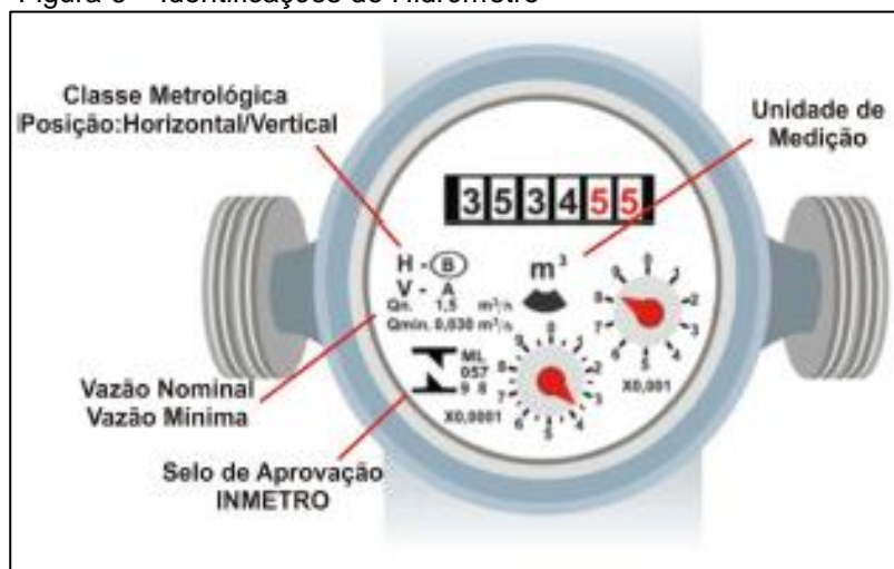
Figura 6 – Identificações do Hidrômetro
