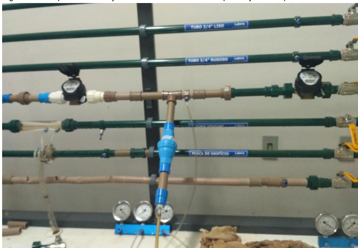
Figura 14 – Esquema de medição somente ar na rede sem a presença do bloqueador
