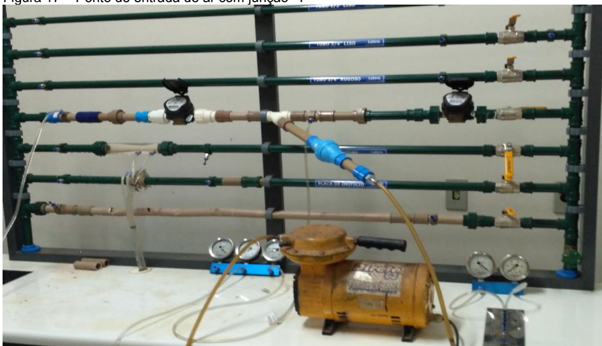
Figura 17 – Ponto de entrada de ar com junção “Y”
